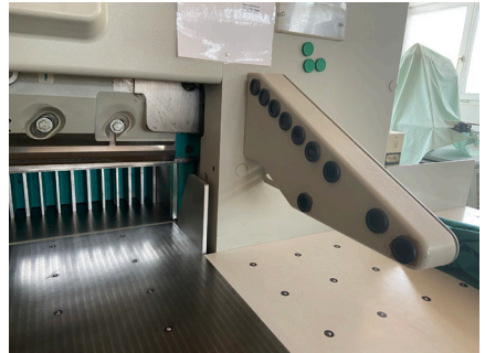
Abbildung: Sensoren an einer Karton Schneidemaschine
